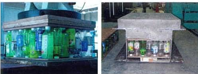
写真-3 鉛直載荷試験およびコンクリート打設試験の状況
